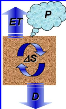
Basis von hydrologischen Untersuchungen und Grundlage jeglicher Stofftransport - Fragestellung ist die detaillierte Kenntnis der Wasserbilanzparameter. Mit dem Hydro-Lysimeter werden die Bodenwasserparameter und deren Schnittstellen zu Atmosphäre und Aquifer direkt gemessen. Für einen beliebigen Zeitschritt lautet die Wasserbilanzgleichung:
